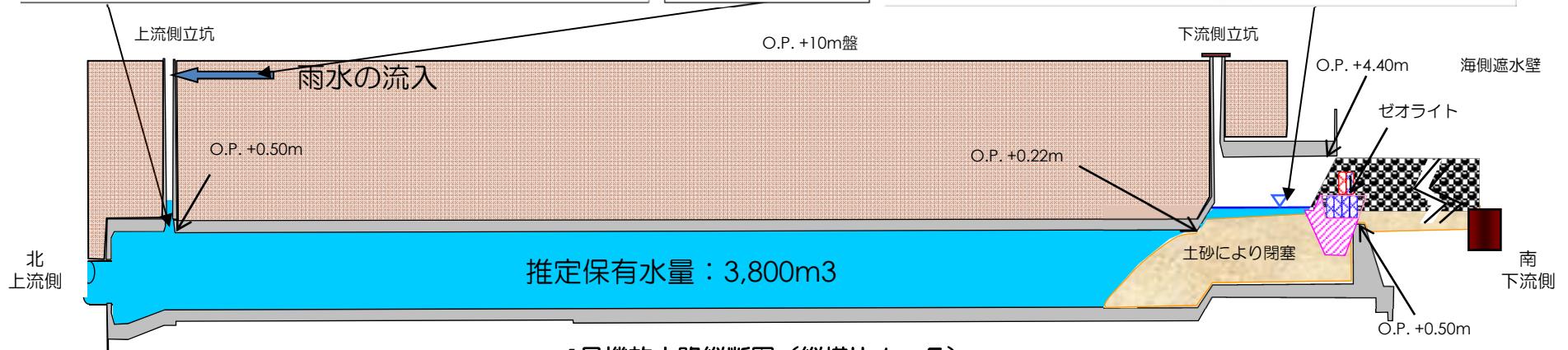
1号機放水路縦断図 (縦横比 1 : 5)
