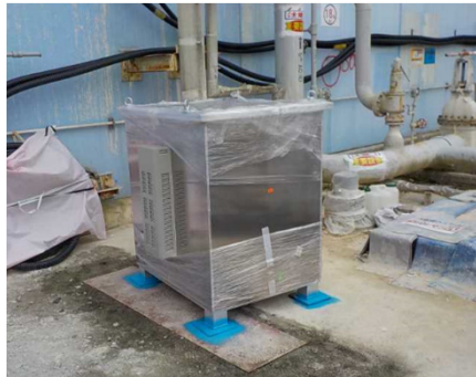
小型ミュオン測定装置※1（2号機の設置実績） （約1m×1m×高さ1.3m）
