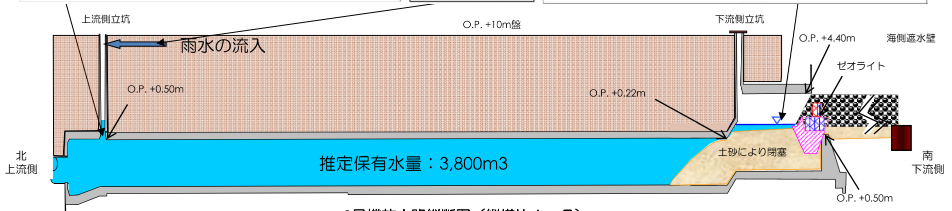
1号機放水路縦断面図（縦横比1：5）
