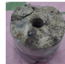
①コンクリートコアB 屋上側 (1RB-OP-C2-1)
