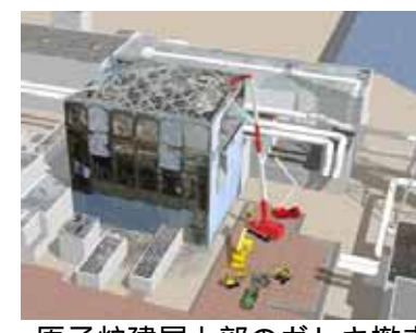
原子炉建屋上部のガレキ撤去
