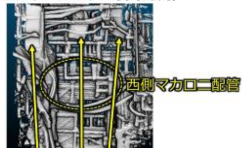
3D-LiDARで取得した点群 (コンプトンカメラの視野方向)
