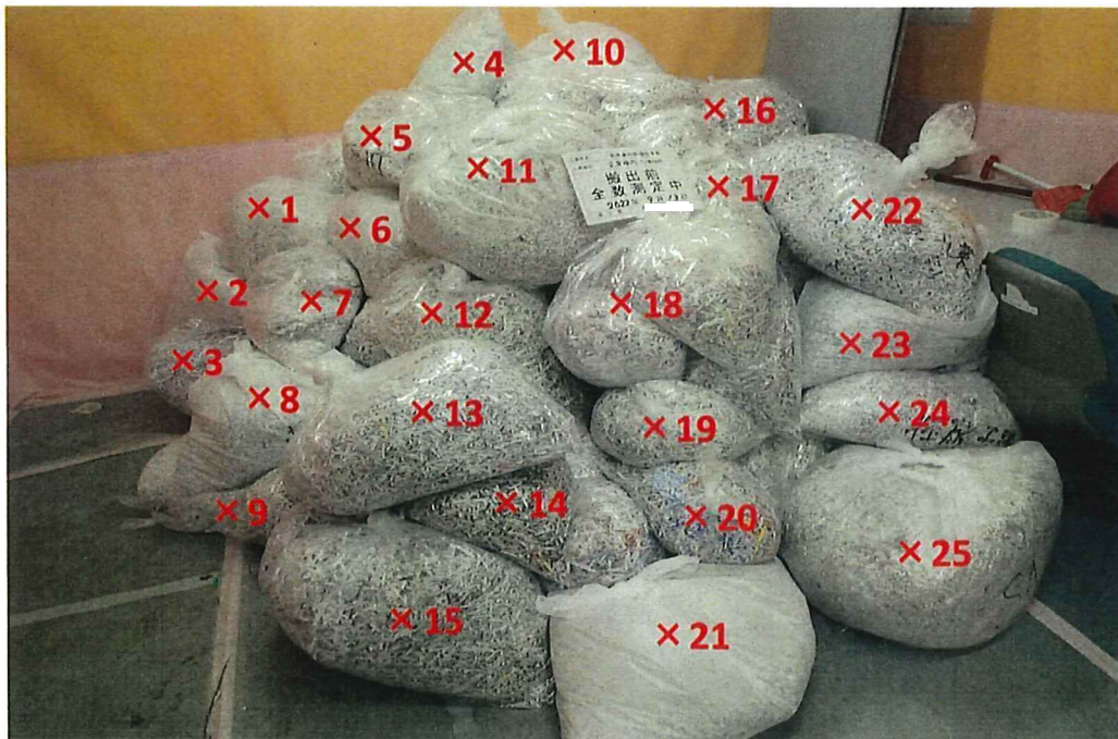
シュレツダー屑 表面線量率測定結果 ( \mu\text{Sv/h} )
