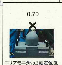
エリアモニタNo.3横に線量表示器を設置。指示値0.7
