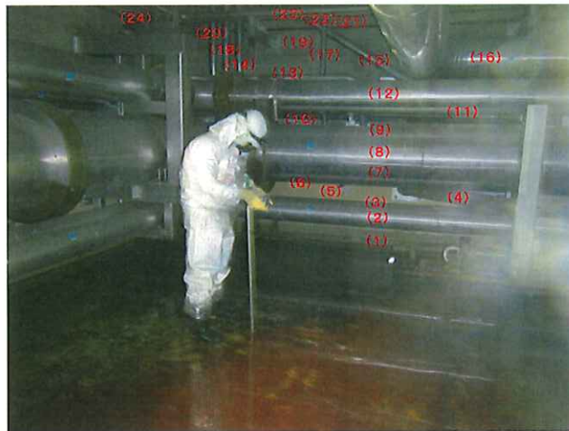
図 5.2④-2-8 O. P. 4900 エリア南西配管表面線量測定
