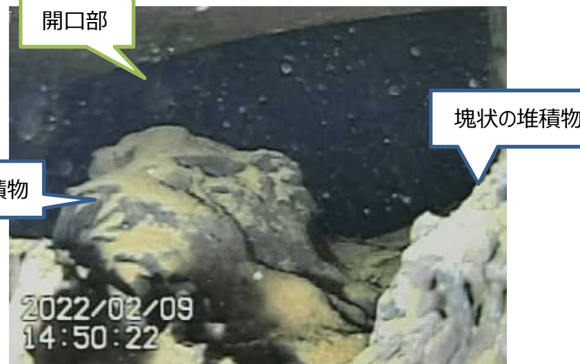
C. ペDESTAL開口部内部
