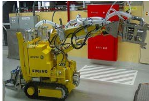
高圧水除染装置
