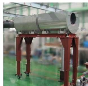
架台及び遮へい容器を組立て設置
