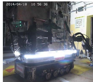
図1 除染時の作業ロボット
