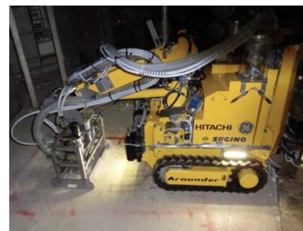
図1 除染時の作業ロボット
