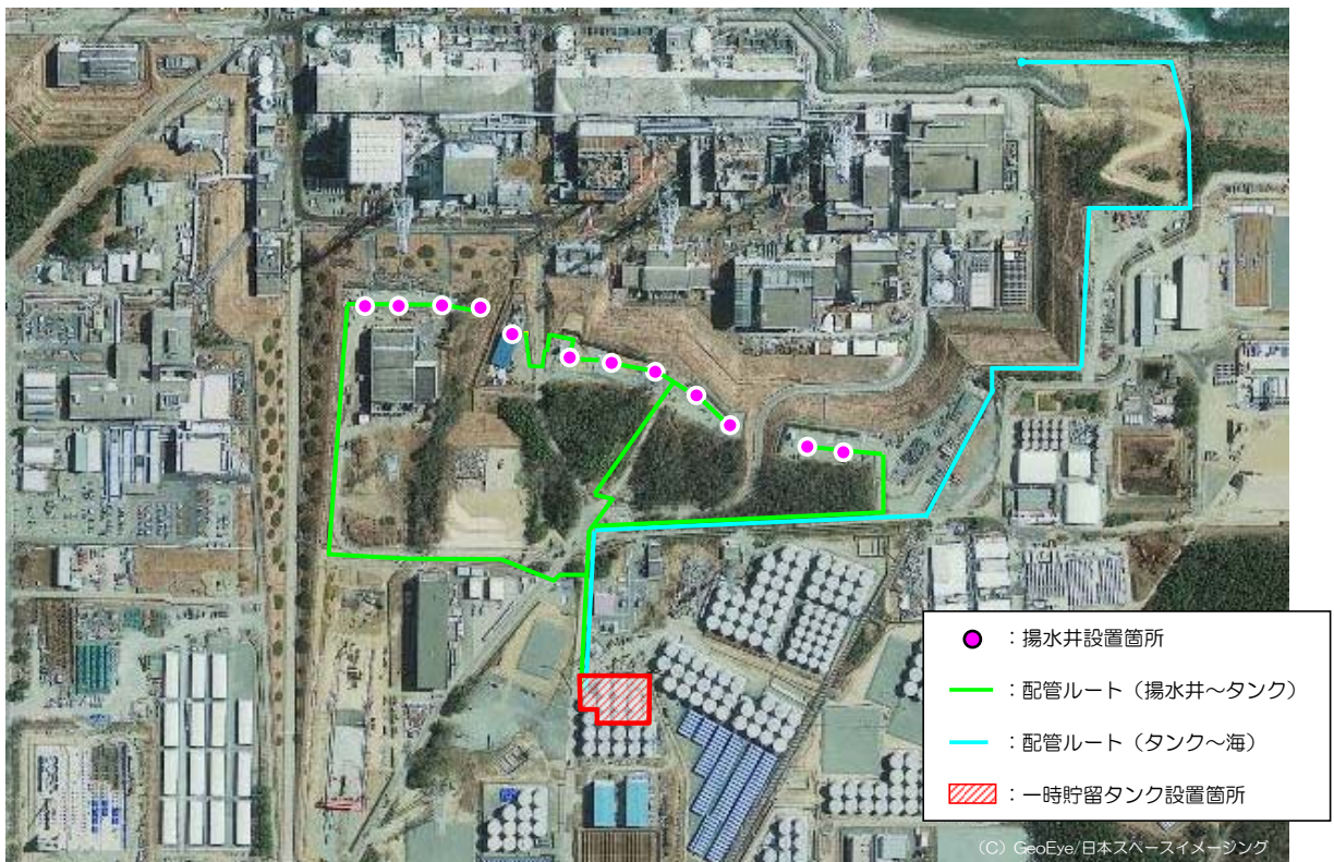
図2 地下水バイパスの設備
