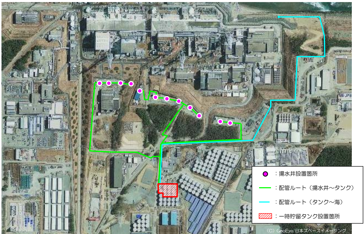
図2 地下水バイパスの設備
