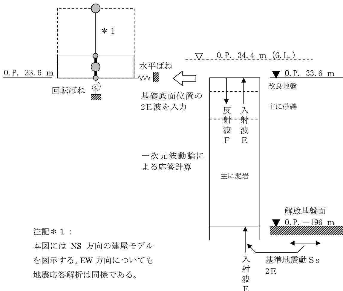
図-19 地震応答解析に用いる入力地震動の概念図
