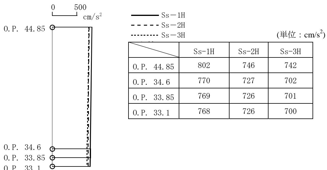
図-1-2 最大応答加速度 (EW 方向)
