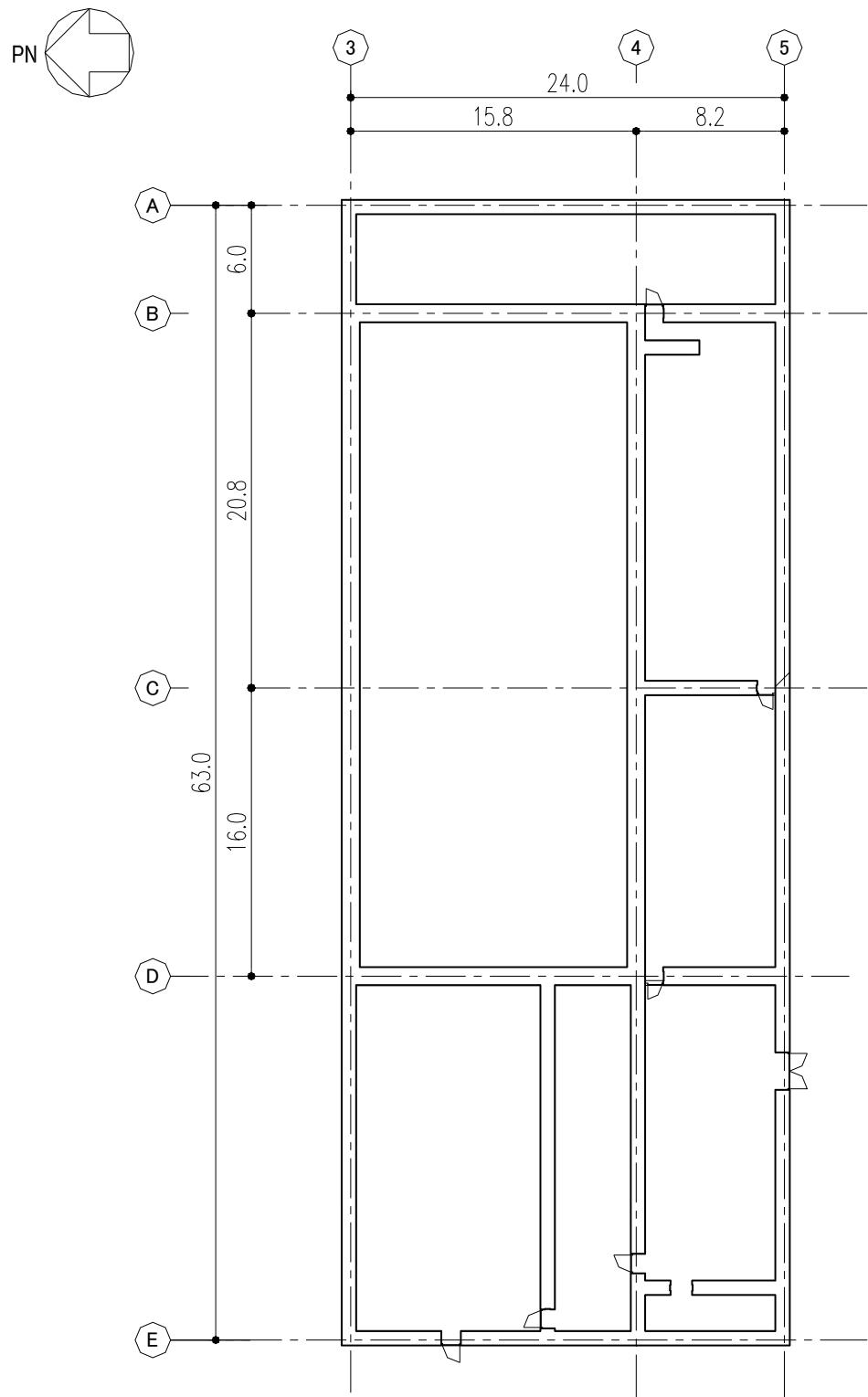
図-1 スラッジ棟 建屋平面図 (O.P. 34.6) (単位: m)
