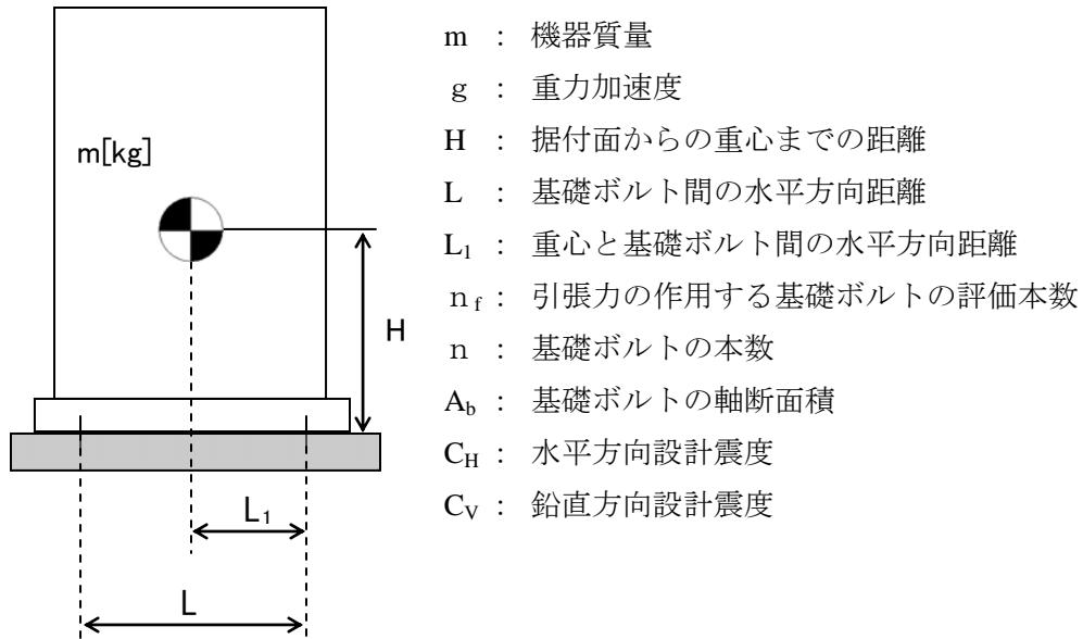
$$\text{基礎ボルトに作用する引張力} : F_b = \frac{1}{L} (m \times g \times C_H \times H - m \times g \times (1 - C_V) \times L_1)$$
