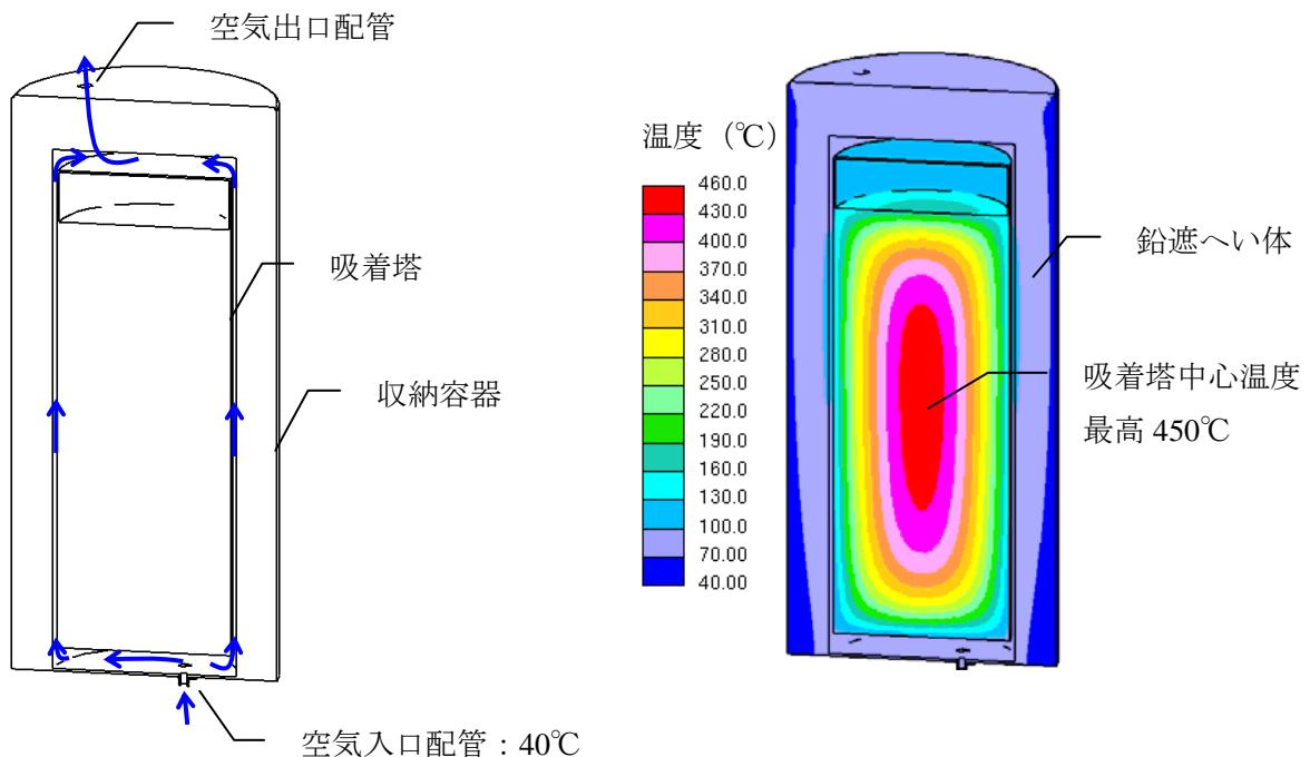
図-3 吸着塔と収納容器隙間の自然
