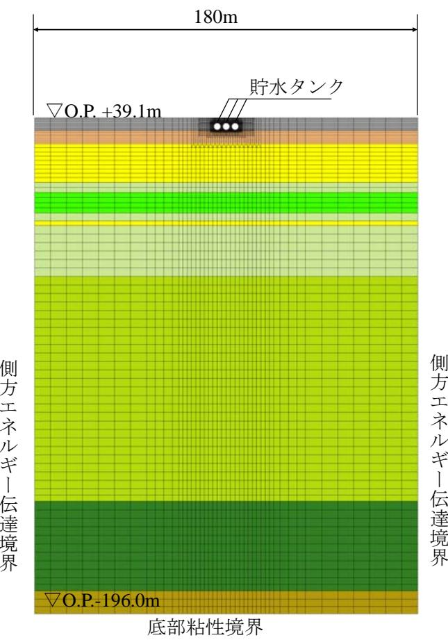
図-7 解析モデル（基準地震動 Ss 評価）
