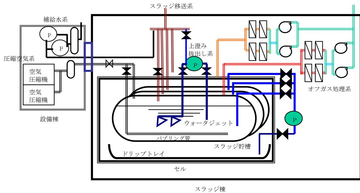
図-8 廃スラッジ一時保管施設概要図
