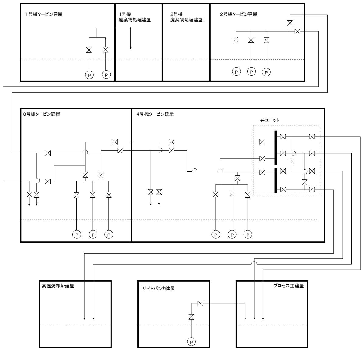
(b) 移送装置系統図概略図
