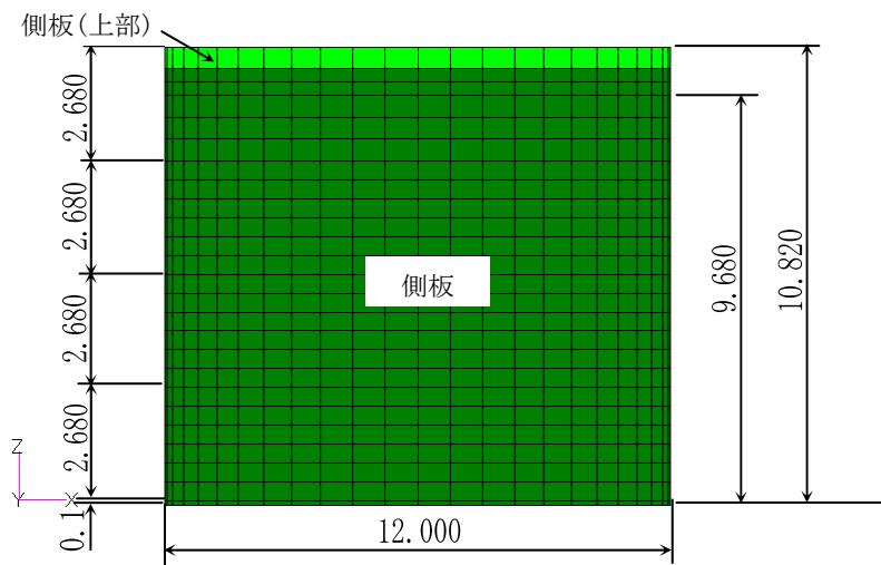
図-3 解析モデル(側面図) 単位:m
