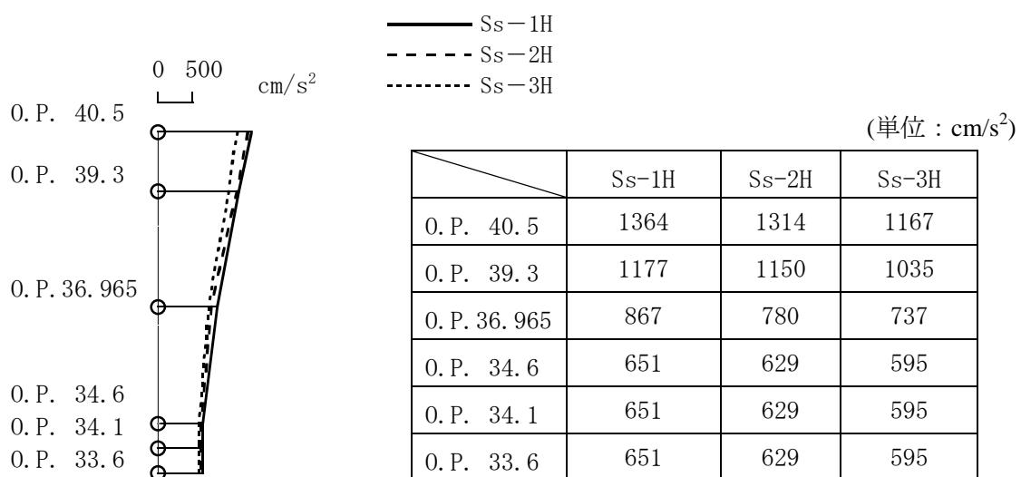
図-25 最大応答加速度 (EW 方向)
