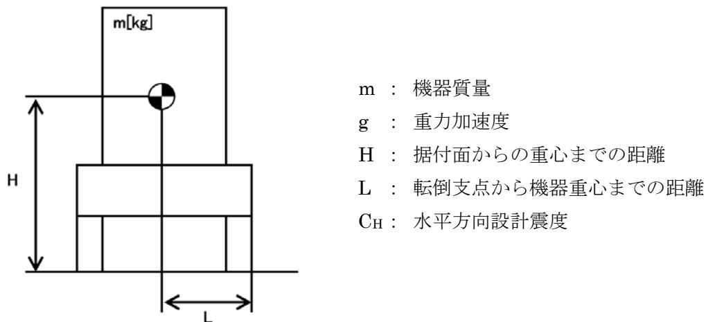
$$\text{地震による転倒モーメント} : M_1 [\text{N} \cdot \text{m}] = m \times g \times C_H \times H$$
