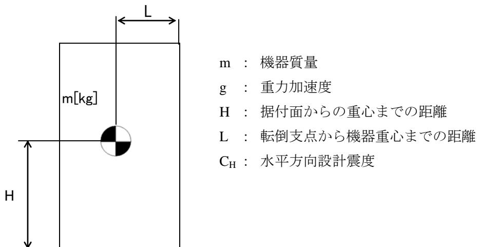
$$\text{地震による転倒モーメント} : M_1 [N \cdot m] = m \times g \times C_H \times H$$
