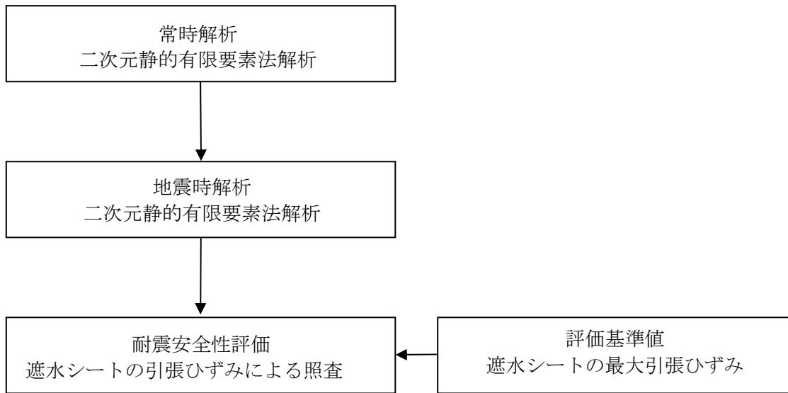
図-2 貯水槽の耐震評価フロー
