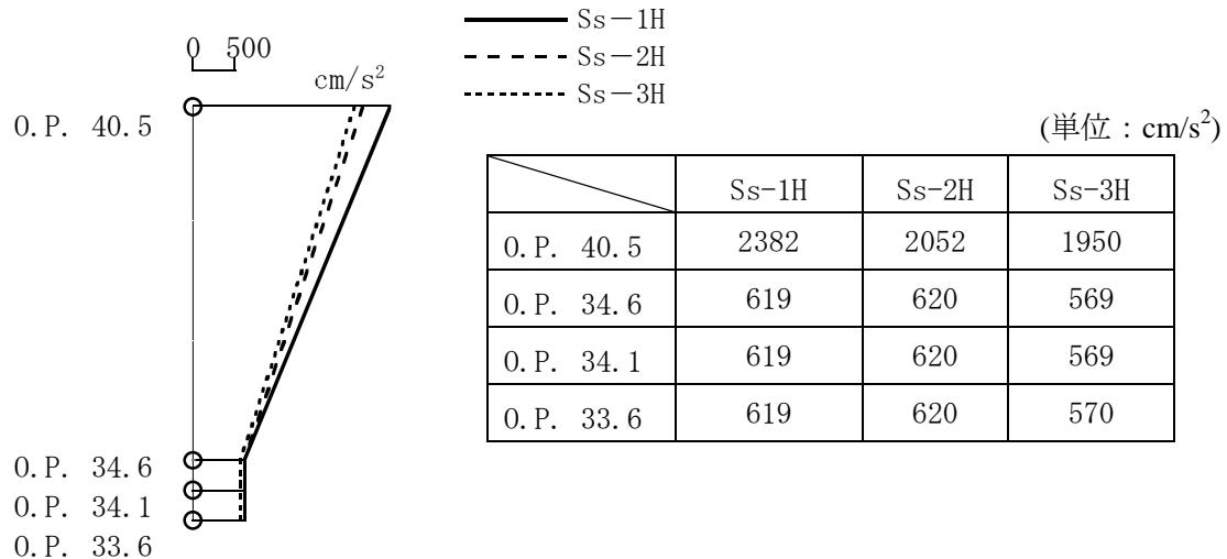
図-24 最大応答加速度 (NS 方向)
