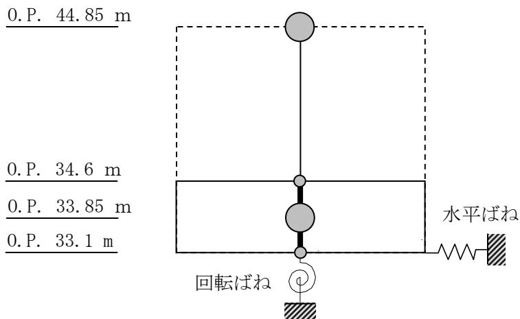
図-9 スラッシュ棟建屋 地震応答解析モデル (NS 方向・EW 方向)
