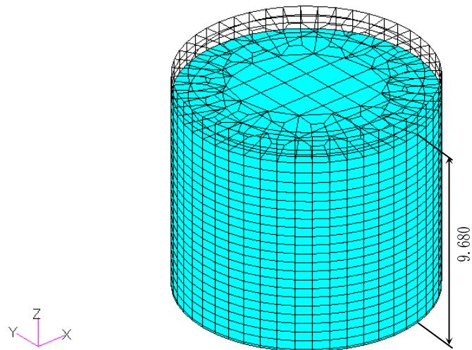
図-2 解析モデル(鳥瞰図) 単位:m
