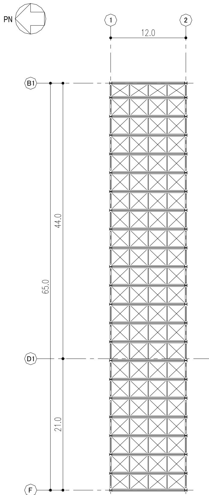
図-14 設備棟 屋根平面図 (O.P. 41.0) (単位:m)
