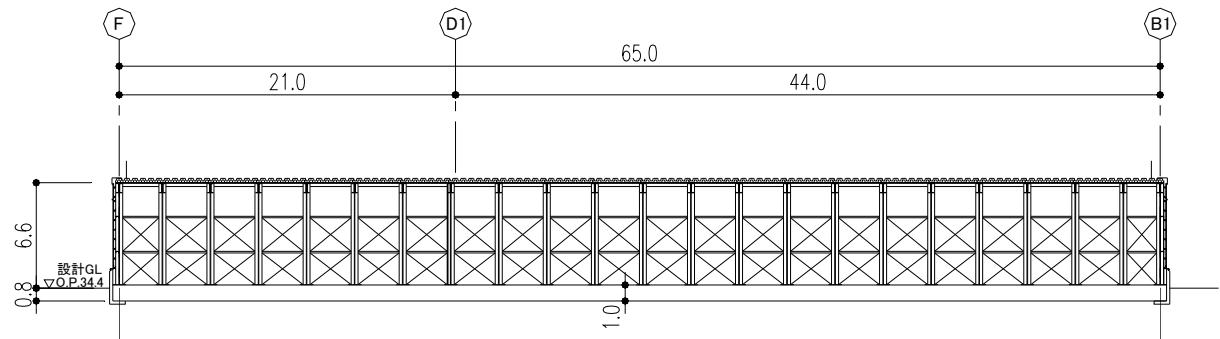
図-16 設備棟 B-B断面図 (EW方向) (単位:m)
