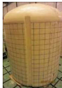
補強リング取り外し後
