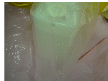
養生内にて漏水を確認
