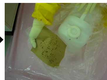
ウエスにより拭き取り、漏水を確認した
