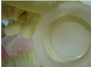
試験前に異物(バリ)の状態を確認 バリはポリエチレン容器より剥がれ、栓側に付着していた
