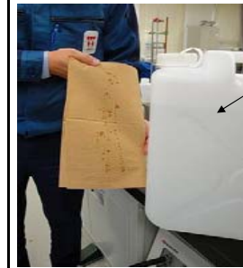
1/6回転開にて漏水確認
