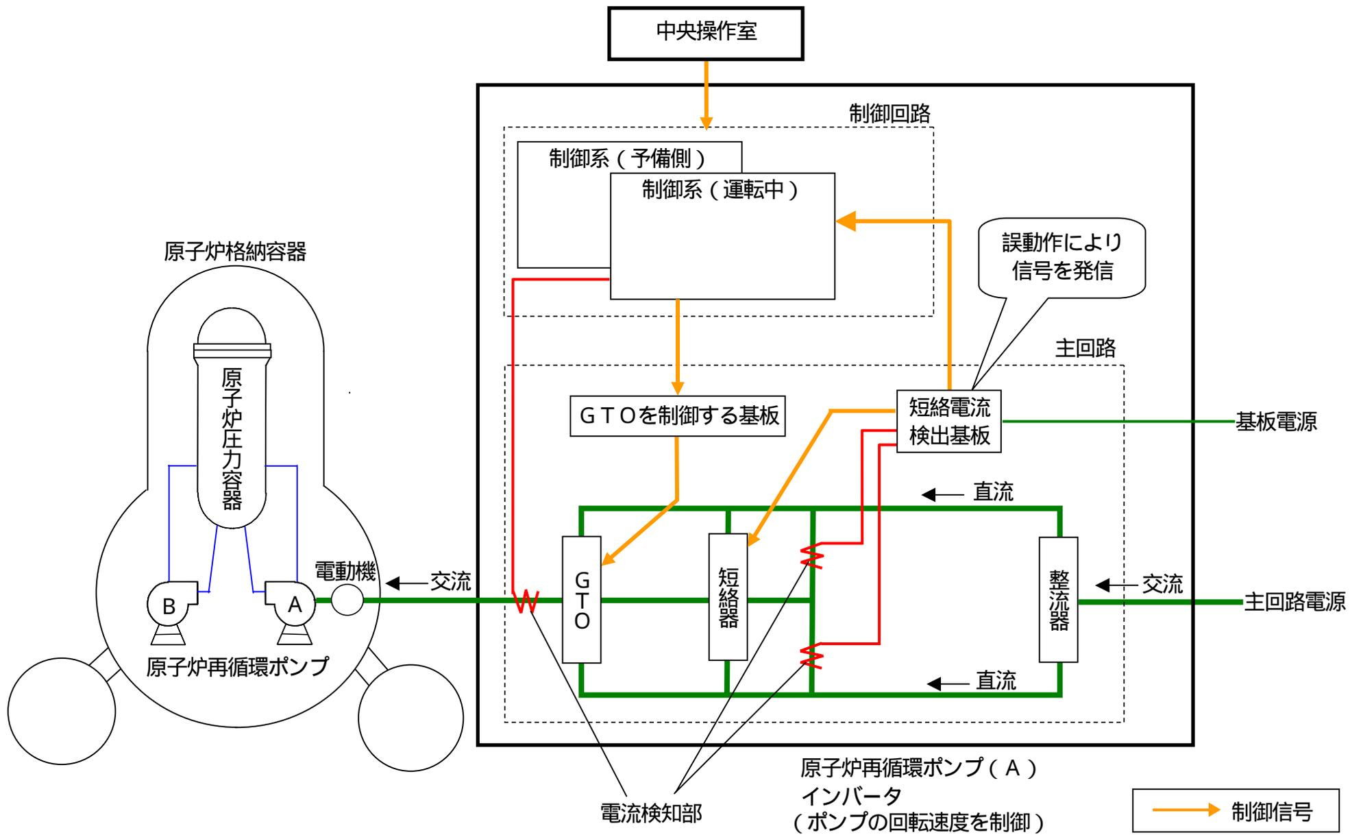
福島第一原子力発電所2号機原子炉再循環ポンプ制御の概要図
