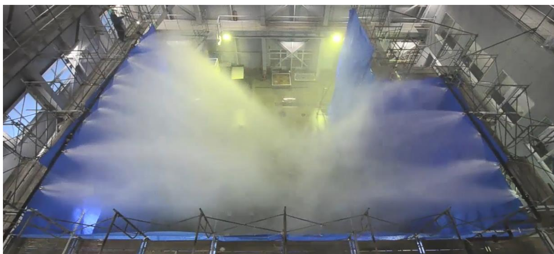
図9 スプレイ状態の試験状況（スプレイ量：132m 3 /h）
