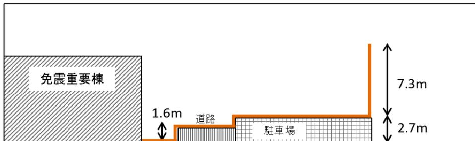
図添 1-5-5 免震重要棟グランドシャイン線評価モデル（断面図）（橙色部：線源領域）
