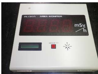
図 2.7-1 可搬型エリアモニタ外観
