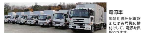
空冷式ガスタービン発電機車 各号機へ電源を供給できます。この燃料を確保するため、地下軽油タンク(5万リットル×3基)も設置しました。
